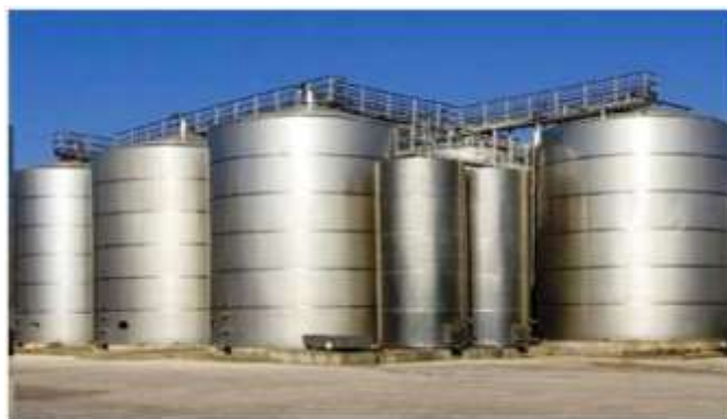
Figure 24 : Fermenteur de production d'Oméga-3 à partir de microalgues (Fermentag., 2013).
